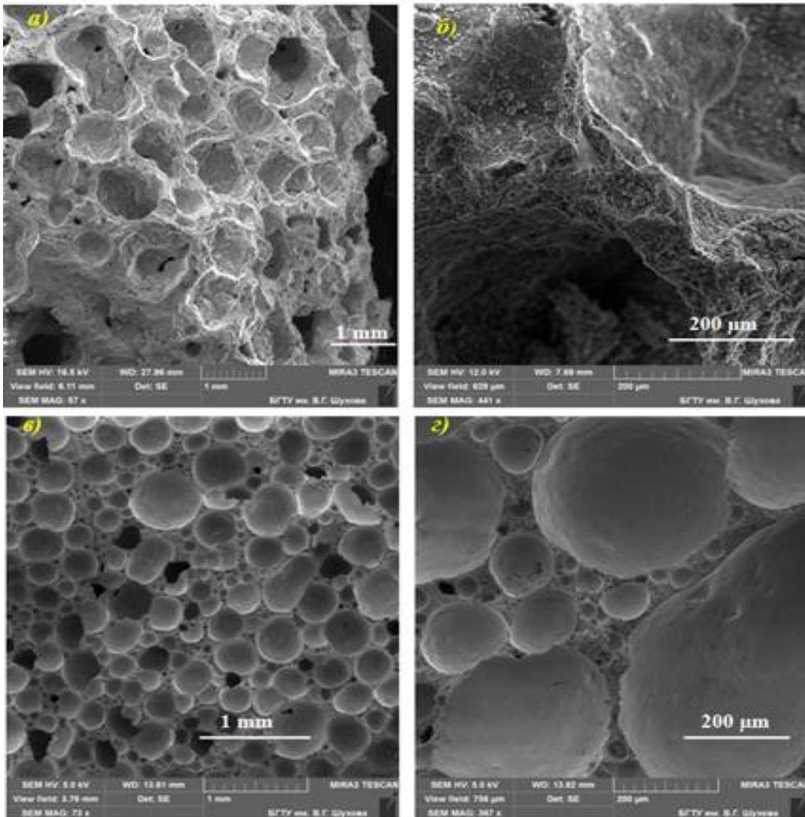
Рис. 4. Пористая структура газобетона:
