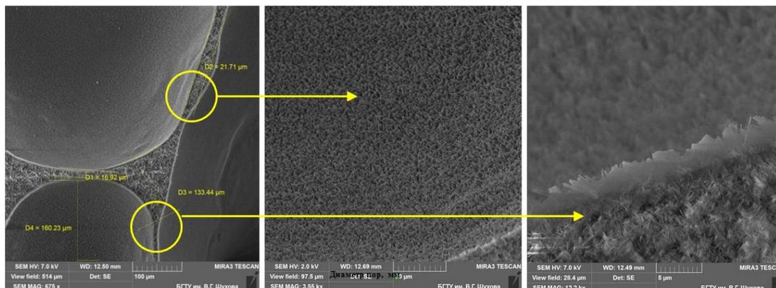
Рис. 5. Межпоровая перегородка газобетона на композиционном вяжущем
