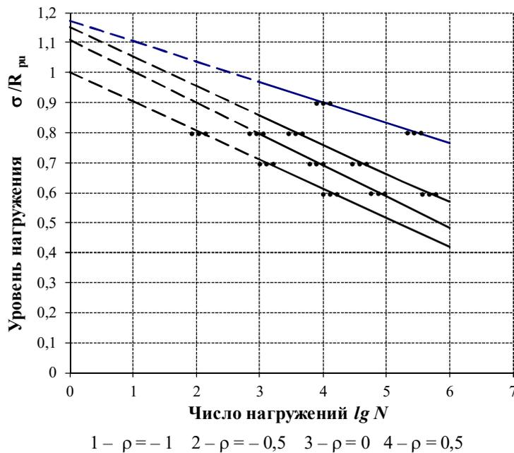
Рис. 7. Линии регрессии по результатам усталостных испытаний.  $lg N$  – логарифм числа циклов, соответствующий пределу выносливости;  $R_{рп}$  – предел прочности материала на растяжение при изгибе
