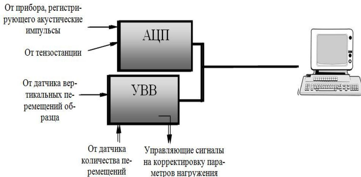
Рис. 2. Схема блока сбора и обработки информации
