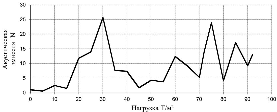
Рис. 6. Зависимость акустического спектра от нагрузки
