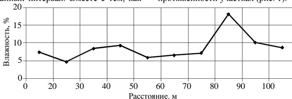
Рис. 1. Изменение влажности грунтов земляного полотна по результатам георадарного обследования
