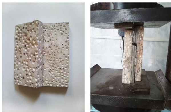
Рис 2. Характер разрушения силикатных материалов с АГЗ на кладочных растворах традиционных составов
