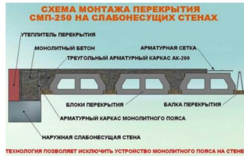
Рис. 8. Варианты сборно-монолитные перекрытия «ЮНИЛИТ»
