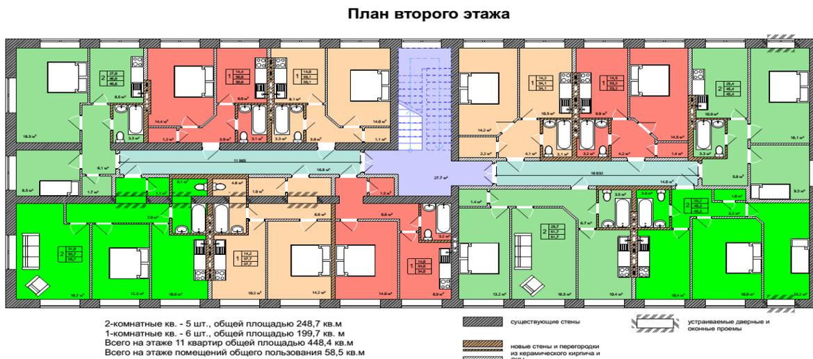
Рис. 7. План второго этажа после реконструкции
