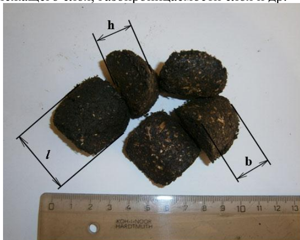
Рис. 3. Брикеты, спрессованные из топливосодержащей шихты с нефтешламовым связующим
