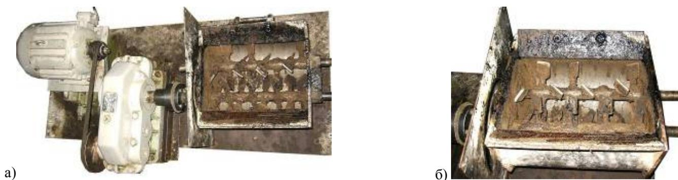
Рис.1. Мешалка лабораторная (с горизонтально расположенными валами с лопатками)
