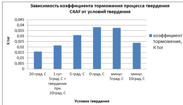
Рис. 15, 16, 17 Зависимость начальной скорости, коэффициента торможения и коэффициентов а и b процесса твердения С<sub>4</sub>АF от условий твердения
