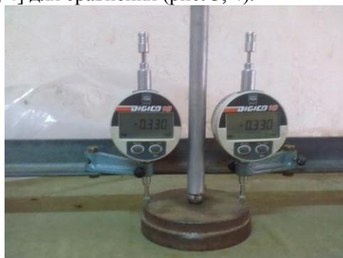
Рис. 2. Измерение перемещения штампа датчиками электронного типа DIGICO 10
