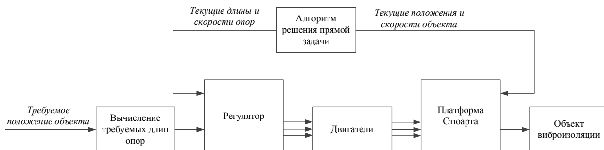
Рис. 3. Общая структура системы виброизоляции
