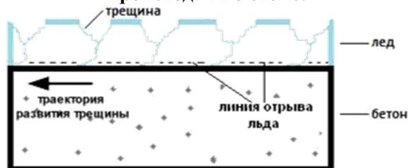
Рис. 1. Модели разрушения поверхностного слоя системы «лед – бетон»
