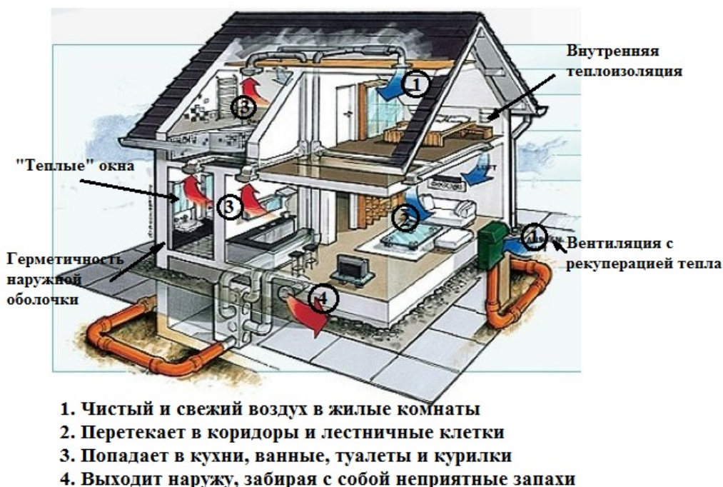
Рис. 4. Организация приточно-вытяжной вентиляции
