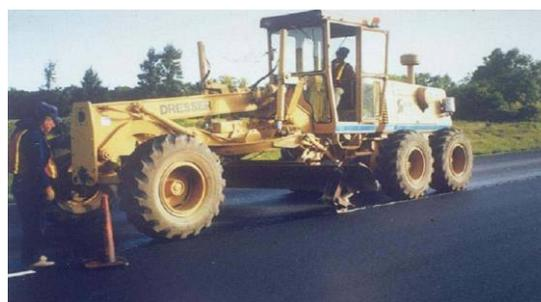
Рис. 12. Установка отрезного диска на автогрейдере
