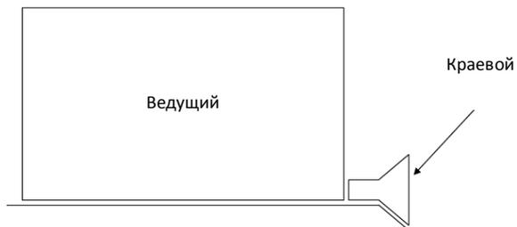
Рис. 18. Схема конструкции краевого уплотнителя
