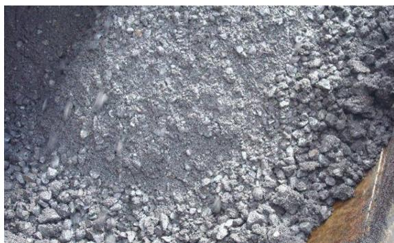
Рис. 6. Гранулометрическая сегрегация смеси при выгрузке
