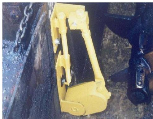
Рис. 20. Крепление на асфальтоукладчике
