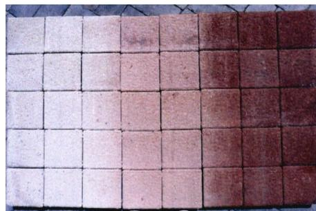
Рис. 3. Партия готовых изделий из цветного бетона, размещенная на поддоне
