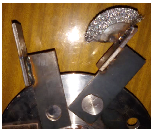
Рис. 7. Варианты конструкций плоских и щеточных бил
