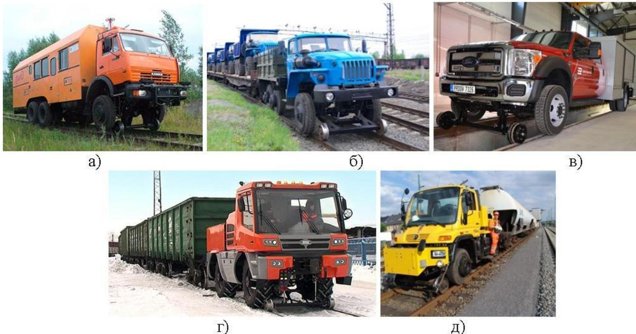
Рис. 1. Автомобильная техника на комбинированном ходу
