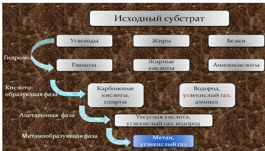
Рис. 2. Процессы образования биогаза
