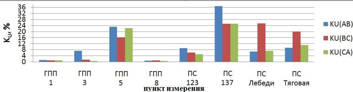
Рис. 1. Значения суммарных коэффициентов гармонических составляющих напряжения  $K_U$ , %
