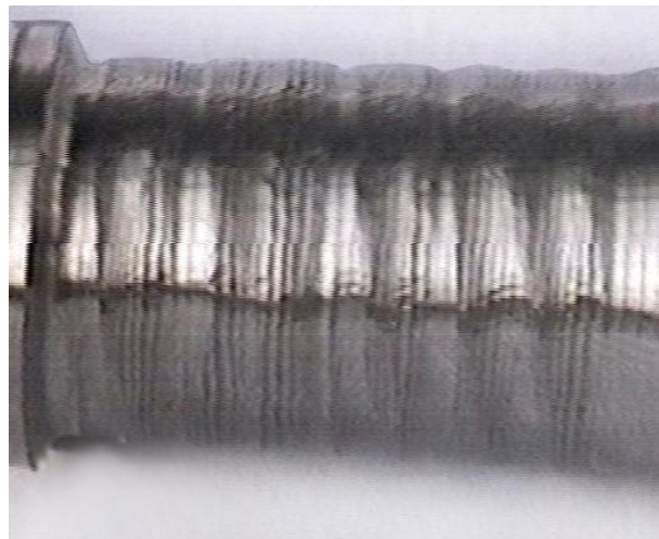
Рис. 1. Обработанная поверхность заготовки при работе колебательной системы в области неустойчивых колебаний (увеличение \times 2 ).
