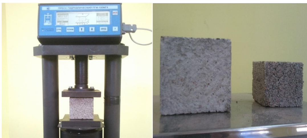
Рис.2. Испытание бетонных образцов на прочность
