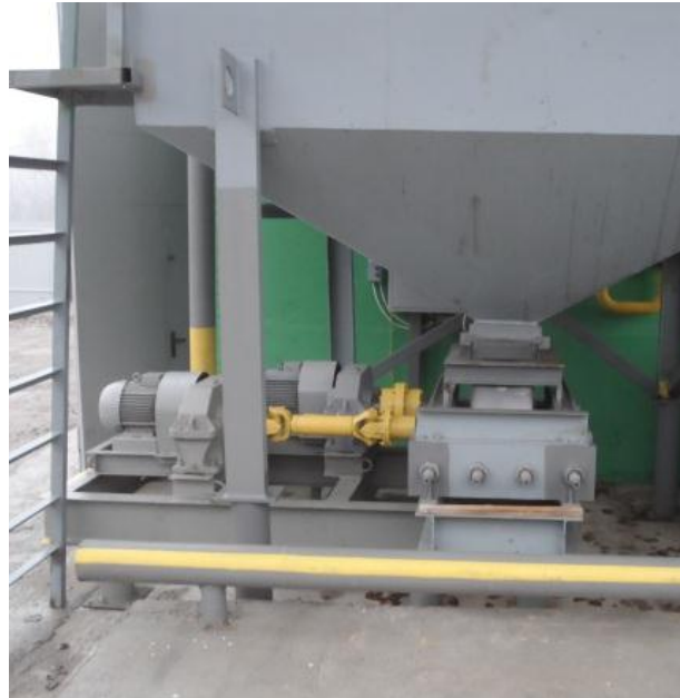
Рис. 2. Пресс-валковый измельчитель: а - общий вид, б - вид на валки
