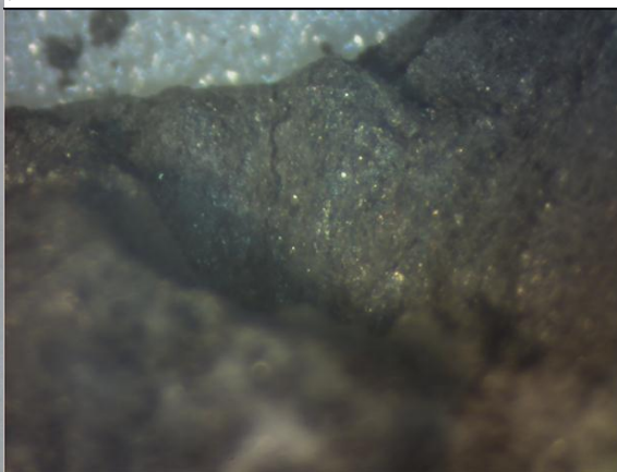
Рис.3. Шлак измельченный в ПВИ: а - товарная форма; б - микродефектная структура (x 80)
