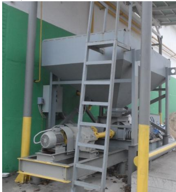
Рис. 2. Пресс-валковый измельчитель: а - общий вид, б - вид на валки
