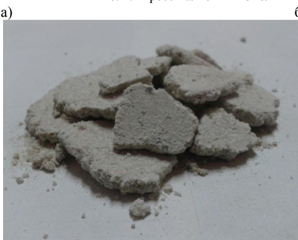
Рис.3. Шлак измельченный в ПВИ: а - товарная форма; б - микродефектная структура (x 80)
