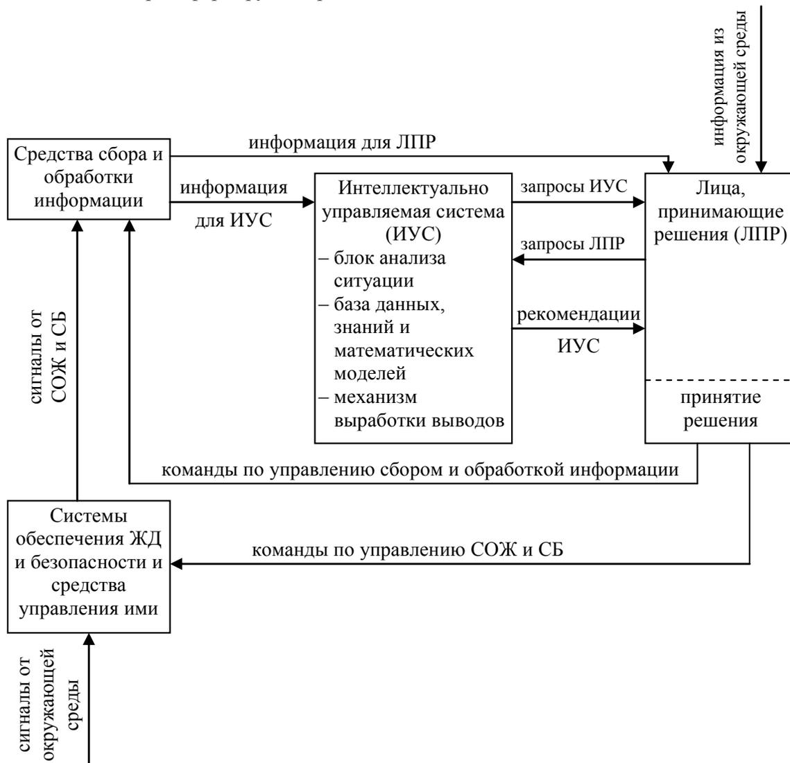
Рис. 1. Структура системы оперативного управления жизнеобеспечением и безопасностью образовательного учреждения при возникновении ЧС
