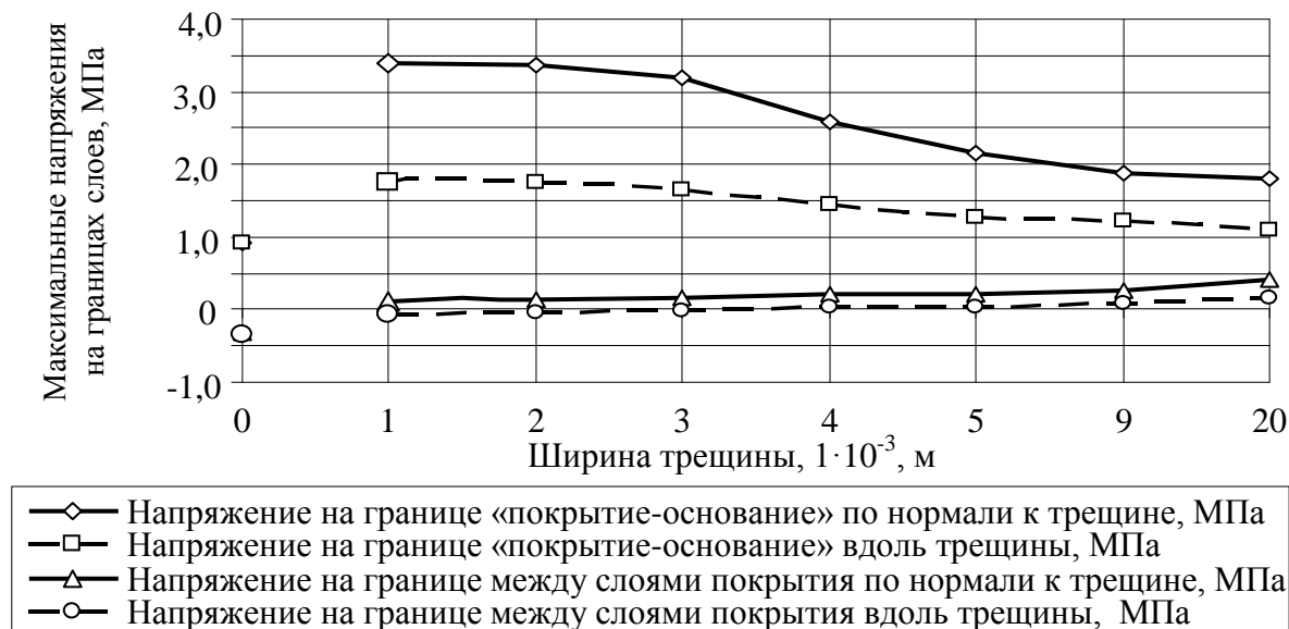
Рис. 4. Связь максимальных напряжений на границах слоев конструкции с шириной раскрытия трещины (модель № 1)
