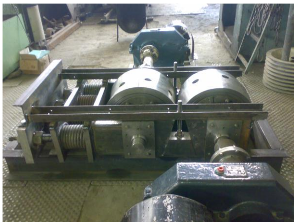
Рисунок 2. Пресс-валковый измельчитель коническими валками
