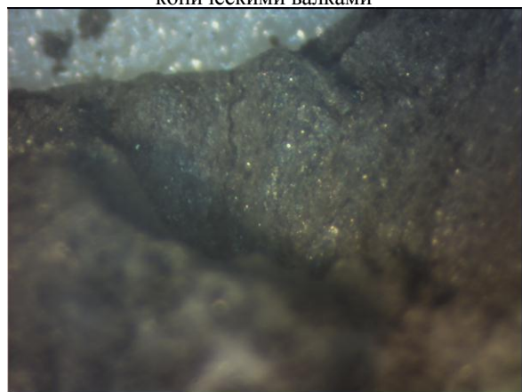
Рисунок 3. Кварцитопесчанник с микродефектной структурой после измельчения в ПВИ
