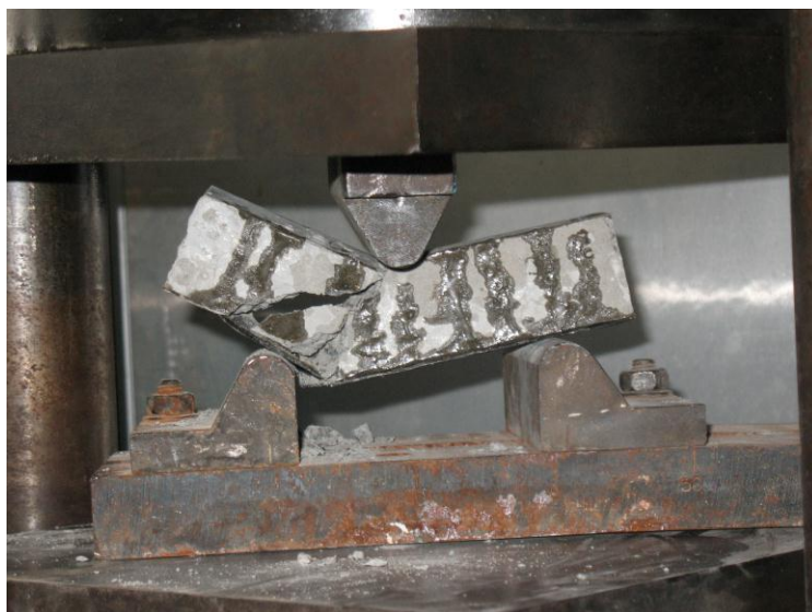
Рисунок 3. Характер разрушения бетонных призм
