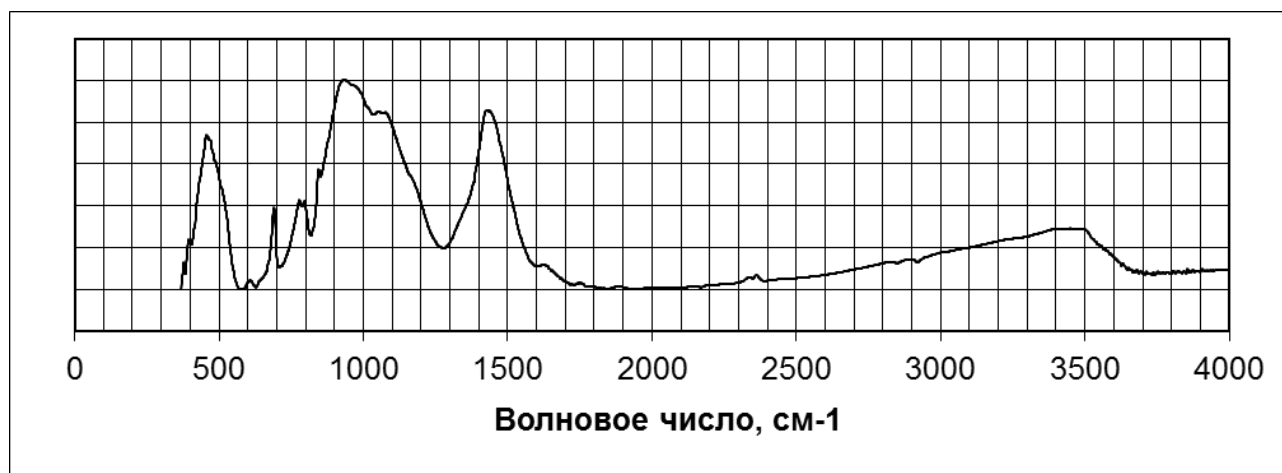
Рисунок 2. ИК-спектрограмма РЗКМ, подверженного кондуктивному прогреванию при 100°C
