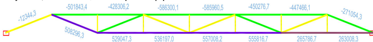
Рис. 2. Цветовая эпюра усилий стержней мостовой фермы после разрушения узла №13
