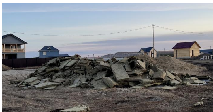
Рис. 1. Отходы использованных минераловатных изделий от зданий и теплотрасс
