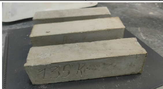
Рис. 9. Образцы-балочки размером 40×40×160 мм, изготовленные из обожженного и измельченного НФ
