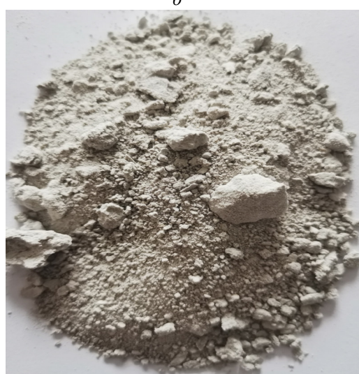
Рис. 1. Внешний вид проб: а – гипсоангидритовый камень (ГАК) Заларинского месторождения; б – нейтрализованный фторгипс (НФ)
