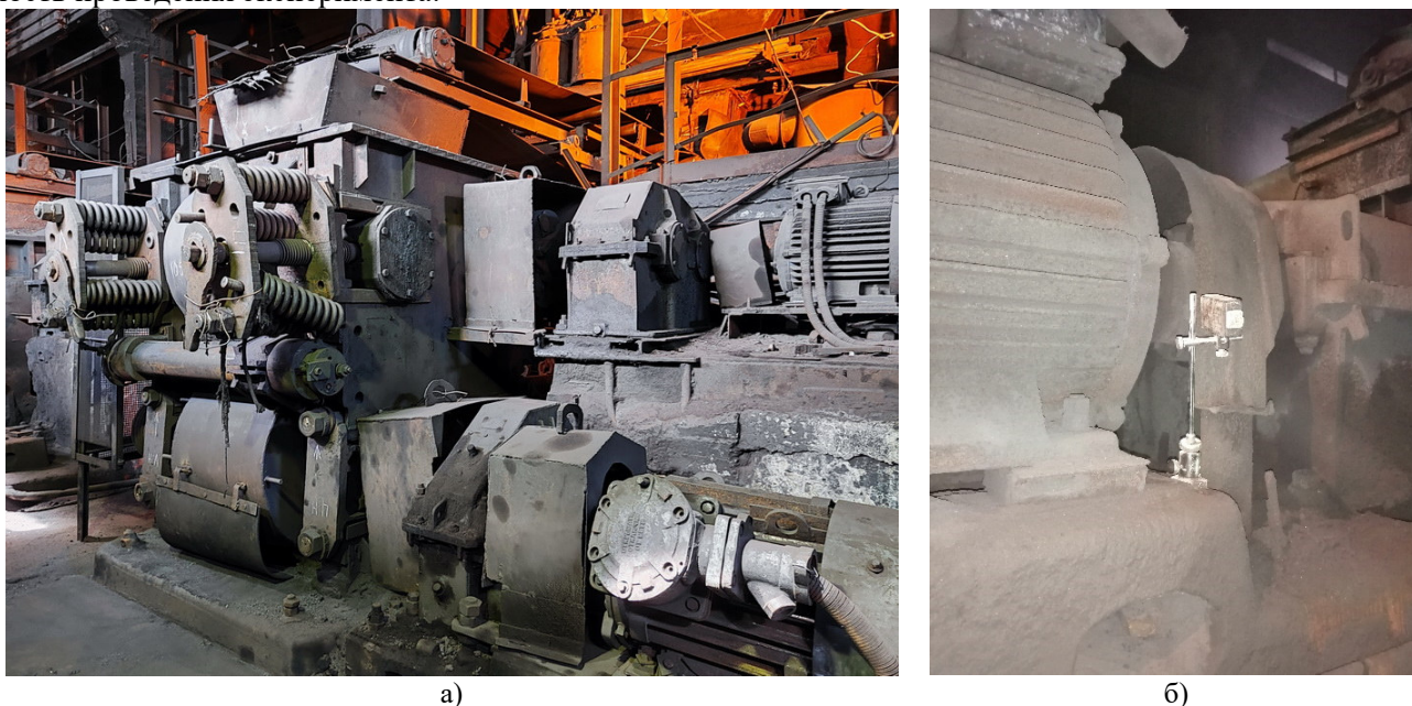
Рис. 2. Дробилка ДЧГ 900×700 (а) и схема установки лазерного отметчика на валу двигателя (б) привода верхних валков при проведении эксперимента
