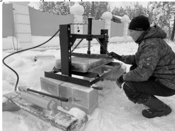
Рис. 1. Испытания фиброльда на трехточечный изгиб
