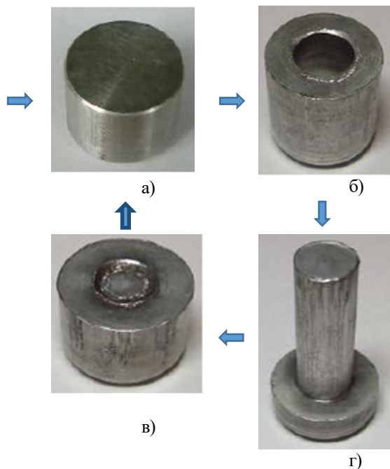
Рис. 5. Образец, подвергнутый обработке методом многократного выдавливания [4, 5]: а) исходная заготовка, б) стакан, в) стержень с утолщением (получен из б); г) образец, полученный после завершения цикла выдавливания (приобретает форму исходной заготовки)
