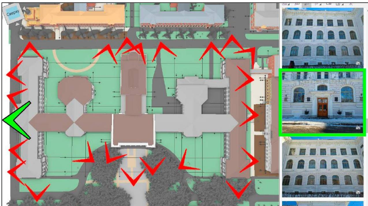
Рис. 9. Автоматическое позиционирование фотографий к модели
