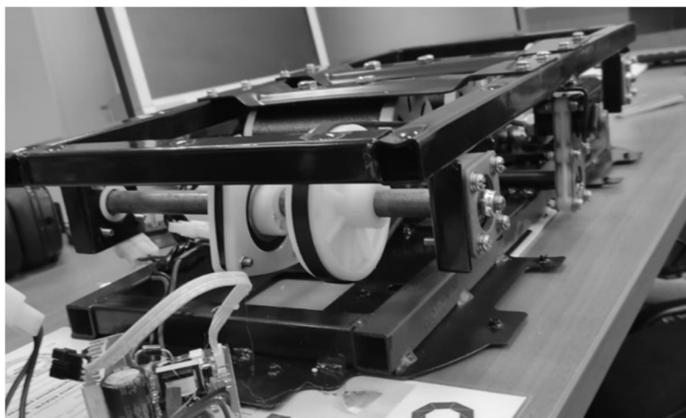
Рис. 5. Виброплатформа штукатурной машины
