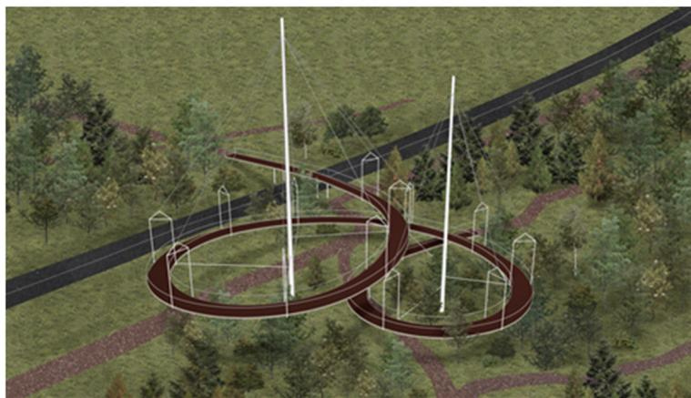
Рис. 4. Общий вид велопешеходного спирального моста через автодорогу. Архитектор Большаков А.Г., 2020
