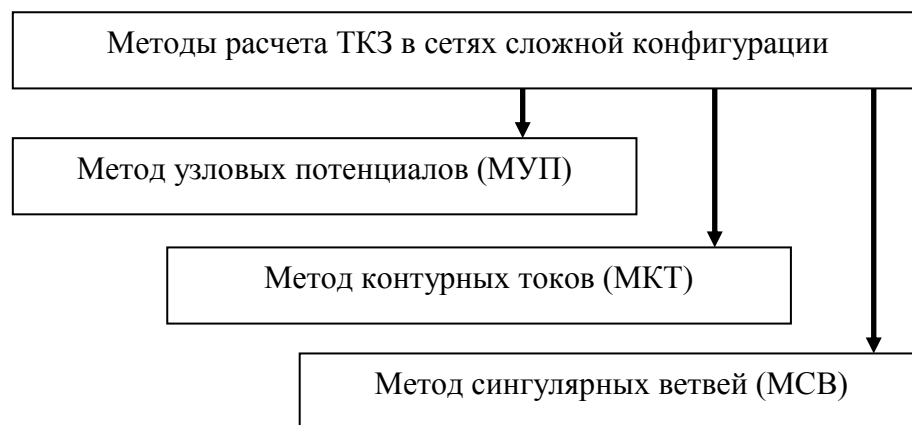
Рис. 1. Методы расчета ТКЗ в сетях сложной конфигурации
