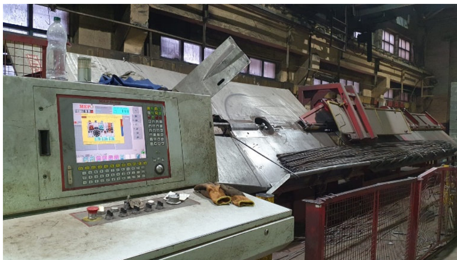
Рис. 8. Разрезка стержней на станке с числовым программным управлением для арматурных каркасов
