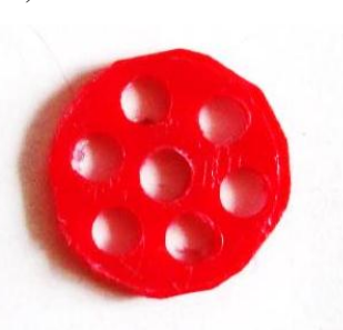
Рис. 2. Смесительная вставка с элементами, имеющими шесть отверстий: а) в сборе б) отдельный элемент
