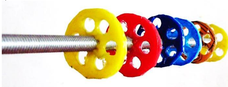
Рис. 2. Смесительная вставка с элементами, имеющими шесть отверстий: а) в сборе б) отдельный элемент
