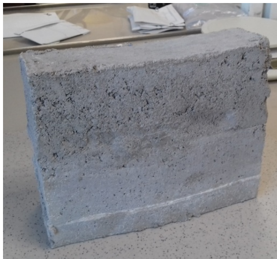
Рис. 1. Образец бетона, полученный по технологии трехмерной печати
