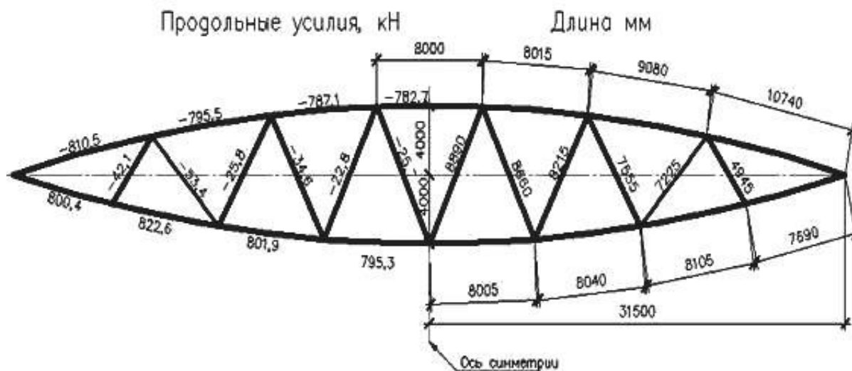
Рис. 2. Пример распределения усилий в стержнях линзообразной фермы
