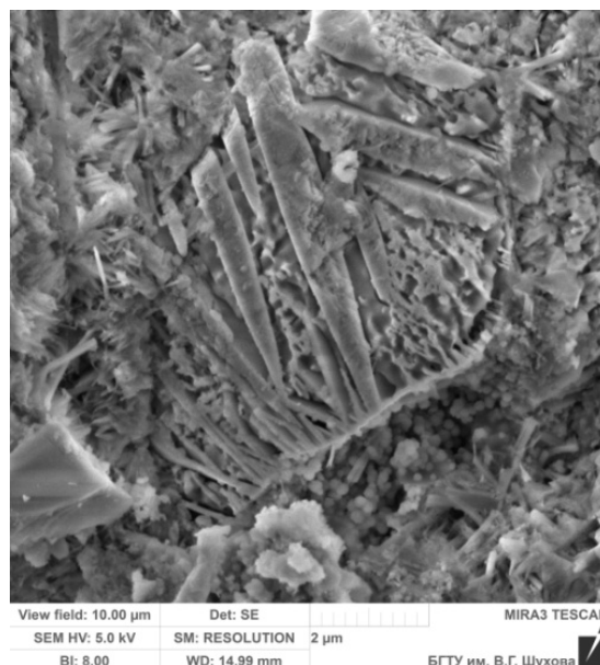
Рис. 6. Микрофотографии вяжущих композиций в возрасте 28 сут состава портландцемент-отходы производства вспученного перлитового песка = 95–5 %, механоактивированные один раз в вихревой струйной мельнице
