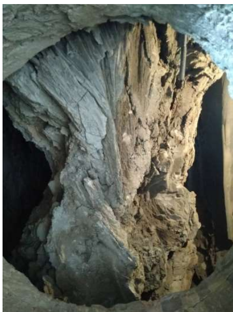
Рис. 1. Настыль в загрузочной части вращающейся печи
