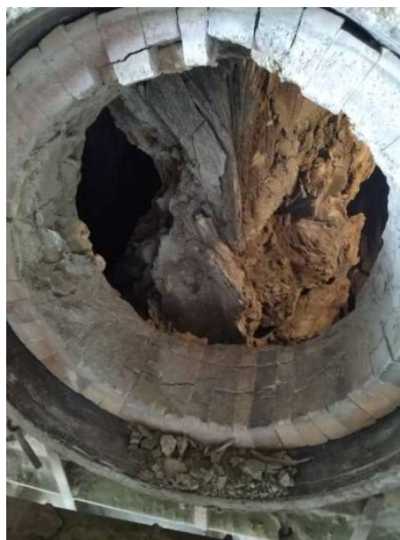
Рис. 1. Настыль в загрузочной части вращающейся печи
