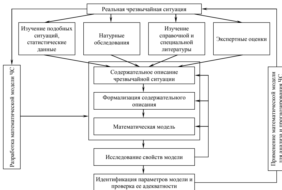
Рисунок 1. Схема построения математической модели
