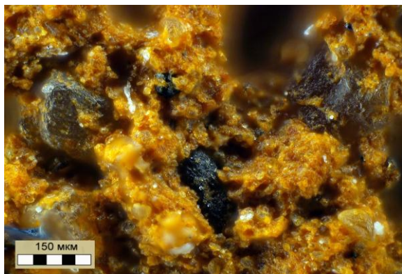
Рис. 10. Микрофотографии полученных образцов: а - контрольный образец, б - образец, содержащий 15% осадка водоочистки
