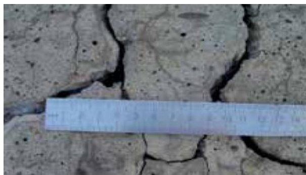
Рис. 2. Дефекты и разрушения железобетонных шпал
