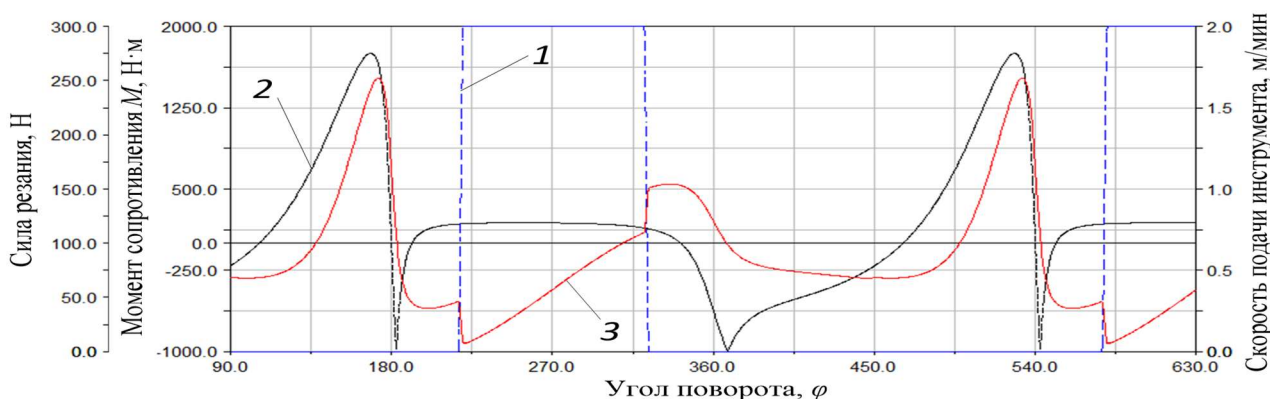
Рис. 7. Результаты моделирования механизма в среде MSC Adams: 1 – сила резания; 2 – скорость подачи инструмента; 3 – момент сопротивления
