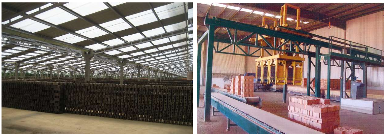
Рис. 5. Процесс производства стенового керамического кирпича из отходов углеобогащения на заводе Хыу Хунг
