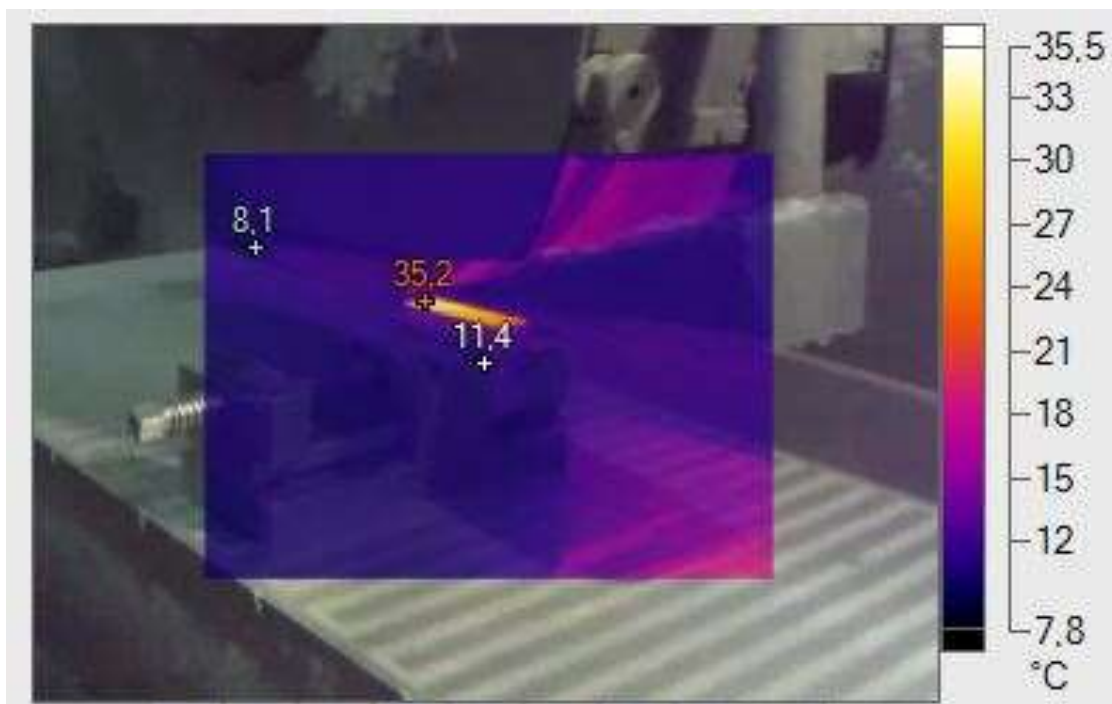
Рис. 2. Диаграмма температурных полей при шлифовании металлополимера WeidlingC
