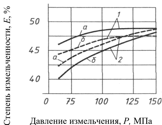
Рис. 4. График зависимости степени измельченности от давления измельчения: а - неотфутерованными валками; б - отфутерованными; 1 - известняк органогенный; 2 - клинкер;
