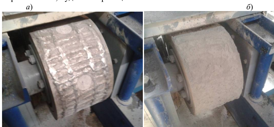
Рис. 3. Валки ПВИ с наплавленной футерующей сеткой на их рабочей поверхности: а – до осуществления процесса измельчения; б – после измельчения
