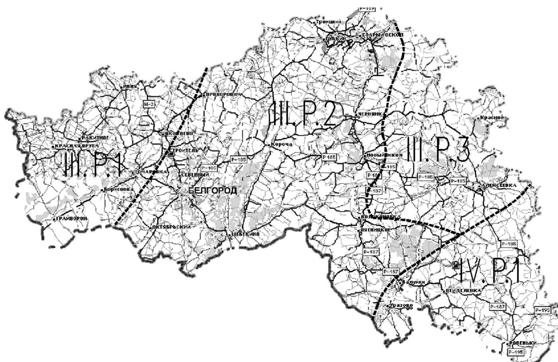
Рис. 2. Схема дорожно-климатического районирования территории Белгородской области: III, IV - дорожно-климатические зоны; P - подзона по типу рельефа (равнинный); 1 - 3 - номера дорожных районов
